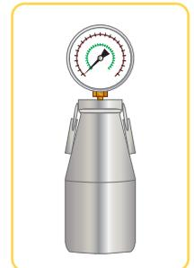
Appareil de mesure de l'humidité CM
