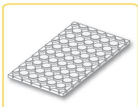
Le panneau compact est une plaque fibre-gypse FERMACELL d'une épaisseur de 18 mm. Il sert de support pour la pose des tubes et de plaque thermoconductrice et convient pour des écarts de 100 mm et 200 mm entre les tubes. Il possède des plots fraisés qui facilitent la mise en place du tube.
